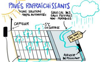
« Le but est de paver une place extérieure avec des pavés au travers desquels on fait passer de l'eau. Cette eau va venir s'évaporer à la surface des pavés. L'intérêt de cette solution c'est qu'elle permet de valoriser l'eau de pluie récupérée [et d'améliorer le confort thermique en surface]. »
