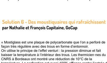
« Mostiglass est une plaque de polycarbonate que l'on a perforée de façon très régulière avec des trous en forme d'entonnoir. On utilise le principe de l'effet venturi : la pression diminue et fait baisser la température à l'intérieur des trous. Les thermiciens du CNRS à Bordeaux ont montré une réduction de 10°C de la température. La performance est aussi 100% efficace contre l'entrée du moustique tigre. »
