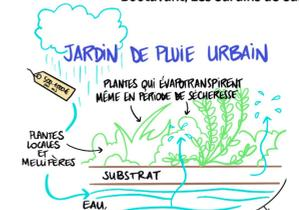
« Aujourd'hui, la gestion de l'eau de pluie en ville se fait surtout avec l'infiltration : le jardin de pluie urbain veut d'abord évapotranspirer et ensuite s'infiltrer. L'idée c'est de déconnecter les eaux de pluie de toiture pour alimenter une réserve d'eau étanche (recouverte) par un substrat planté. Les plantes travaillent ensuite toutes seules : elles évapotranspirent grâce à l'eau dont elles bénéficient. »
